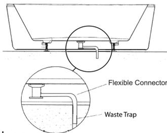
Insérer le tube d'évacuation dans le trou de vidage
